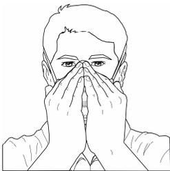
4. Antes de cada uso, realice una prueba de verificación del sello de presión positiva y negativa. Para ello, cubra el respirador con ambas manos, teniendo cuidado de no alterar su posición. Para comprobar la presión positiva, exhale suavemente. Para comprobar la presión negativa, inhale suavemente. Si hay fugas de aire alrededor de la nariz o alrededor de los bordes del respirador, reajústelo de acuerdo con estas instrucciones de colocación y ajuste.
