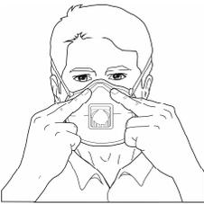
3. Coloque las yemas de los dedos de ambas manos en la parte superior del clip nasal (parte metálica). Deslice las yemas de los dedos a lo largo del clip nasal, desde el centro hasta los extremos, conformándolo de acuerdo con la forma de la nariz. Use ambas manos para ajustar el clip nasal. El uso de una sola mano puede causar un ajuste inadecuado y afectar el sellado y el funcionamiento del respirador.
