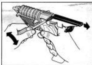
1. Remueva el clip metálico standard del aplicador Polygun TC insertando un destornillador. Rote el destornillador 90°. Vea la figura.
