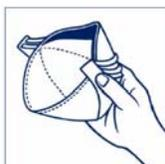
1. El clip nasal está situado en el panel superior. Déle una forma previa doblándolo suavemente por el centro. Sujete el respirador con la mano y tire del extremo del panel inferior para abrirlo.
